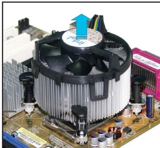
5. Tournez chaque attache dans le sens des aiguilles d'une montre pour qu'elle soit orientée correctement en vue d'une future réinstallation.
