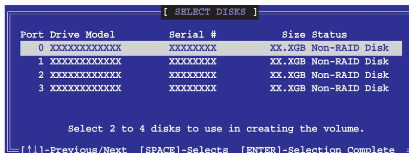
5. Utilisez la touche flèche haut/bas pour sélectionner un disque, puis pressez <Espace> pour sélectionner. Une petite marque en forme de triangle marque le disque sélectionné. Pressez <Entrée> après avoir terminé votre sélection.
