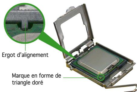
6. Refermez la plaque (A), puis pressez le levier (B) jusqu'à ce qu'il se loge dans le loquet de rétention.
