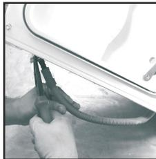
4. Fixez le tuyau noir du kit (en utilisant le connecteur et les étriers de tuyau fournis) au tuyau démonté du raccord.
