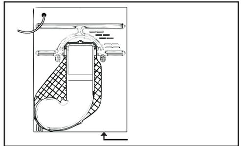
**Important :** Pendant le transport, l'appareil doit être stocké dans sa position normale d'utilisation. Si nécessaire, l'appareil peut être incliné comme montré ci-dessous.
