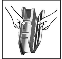
5. Remettez correctement le condenseur en place (en suivant la flèche) en le poussant fermement. Bloquez les deux leviers en position en les tournant dans le sens des aiguilles d'une montre.
