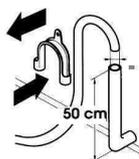
• Rapprocher la machine du mur, en faisant bien attention à éviter tout coude ou étranglement du tuyau, et raccorder le tuyau d'écoulement au rebord de l'évier ou, mieux encore, à un dispositif fixe d'évacuation, au diamètre supérieur au tuyau du lave-linge et au moins 50 cm de hauteur et 75 cm. maximum du sol.
