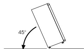
Verwijder het onderste scharnier door de schroeven, dopje en volgring te verwijderen, en verwijder vervolgens de onderste deur
