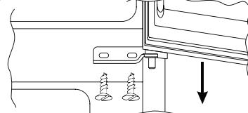
Avlägsna täckpluggarna (A) och (B), skruva loss skruvarna och avlägsna delvis panelen
