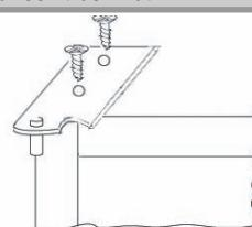
Verwijder het dopje aan de linkerzijde en plaats het aan de rechterzijde van de middelste en onderste inzetstukken.
