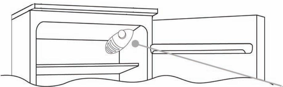
Termostatboksen som kontrollerer apparatet befinner seg opp til høyre i kjøledelen. For å kontrollere at apparatet virker, må du sjekke at termstatens bryter ikke står på „0“.
