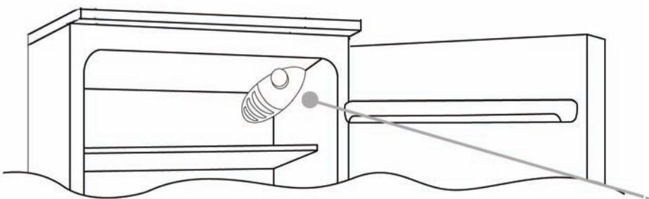
Termostat určený k ovládání spotřebiče je umístěný uvnitř chladničky vpravo nahore. Pokud chcete zkontrolovat, že zařízení opravdu funguje, přesvědčete se, že termostat není nastavený v poloze „0“.
