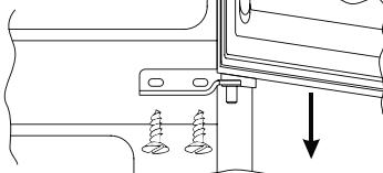
Verwijder de dopjes (A) en (B), draai de schroeven los en verwijder het paneel gedeeltelijk.
