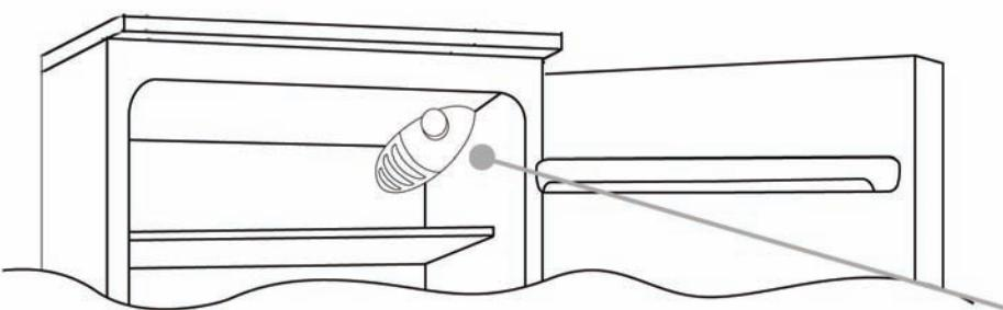
Den termostatboks, der styrer temperaturen i skabet, sidder indvendig i køleafdelingen foroven til højre. Når det kontrolleres, om skabet fungerer, skal det sikres, at termostatknappen ikke står på „0“.
