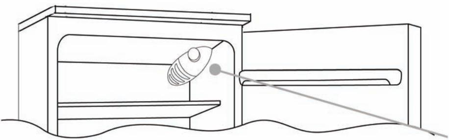
De thermostaatregelaar van het apparaat bevindt zich rechtsboven in het koelkastgedeelte. Om te controleren of het apparaat functioneert dient u erop te letten dat de knop van de thermostaat niet op „0“ staat.
