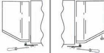
Avlägsna den mittersta skruven och avlägsna den övre dörren
