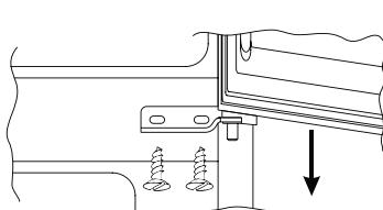
Fjern hettene (A) og (B), skru av skruene og trekk dekselet delvis av.
