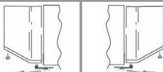
Entfernen Sie die mittlere Schraube und entfernen Sie die obere Tür.
