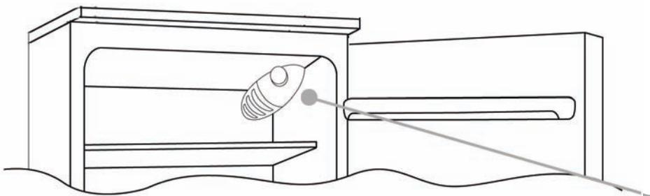
La scatola termostato per il controllo dell'apparecchio è collocata all'interno della cella frigo in alto a destra. Per essere certi che l'apparecchio stia funzionando accertarsi che la manopola termostato non sia sulla posizione **OFF**.
