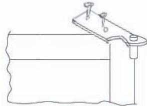
Ota vasen yläsarana laitteen mukana toimitettavasta välinepakkauksesta ja aseta se paikalleen.
