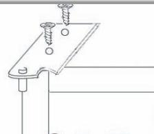
Αφαιρέστε την τάπα της αριστερής πλευράς και τοποθετήστε τη στη δεξιά πλευρά του κεντρικού και κατώτερου προσαρμογέα.
