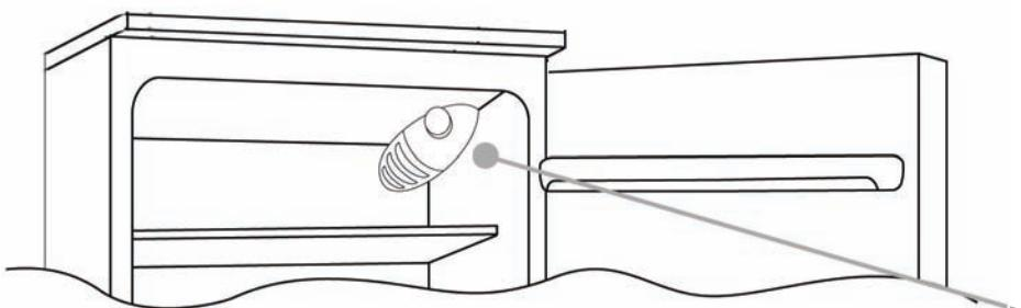
Laitteen säätoön tarkoitettu termostaattilaatikko sijaitsee jääräappiosaston sisällä oikealla ylhäällä. Kun haluat tarkastaa, että laite toimii, varmista, että termostaattinuppi ei ole asennossa "0".
