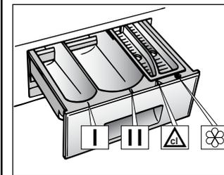
Si vous souhaitez utiliser une lessive liquide, un récipient spécial peut être inséré dans la section "II" du tiroir à lessive. Grâce à ce système, la lessive s'écoulera dans le tambour seulement au bon moment.
