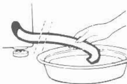
En cas d'éventuels déménagements ou si la machine n'est pas utilisée pendant un certain temps et qu'elle reste dans un endroit non chauffée, il est nécessaire de vider tous les tuyaux de la machine de tout résidu d'eau. Il suffit de détacher de la bande de fixation le tuyau de vidange et plier ceci vers le bas jusqu'à l'évacuation complète de l'eau (dans un récipient). Cette opération terminée fixer le tuyau avec la bande.
