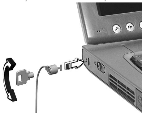
Enroulez le câble du cadenas de sécurité pour ordinateur autour d'une table, de la poignée d'un tiroir verrouillé, ou de tout autre objet fixe. Insérez le cadenas dans l'encoche et tournez la clef pour verrouiller le cadenas. Certains modèles ne possèdent pas d'encoche.
