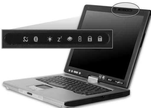
Les indicateurs d'état Alimentation, Batterie et Communication sans fil sont visibles même lorsque l'écran LCD est fermé.
