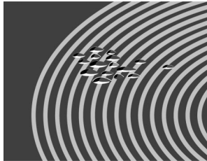
Tache creuse due à du sucre fondu ou à des aliments contenant une forte quantité de sucre.
