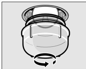
4. Remplacer l'ampoule par un modèle identique.
