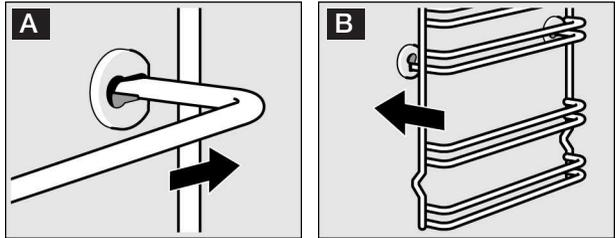
Les supports s'adaptent à droite et à gauche. La courbure doit toujours être en bas.
