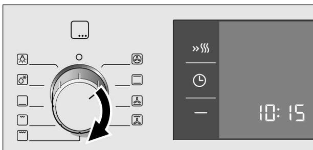
2. Régler la température ou la position gril à l'aide du thermostat.
