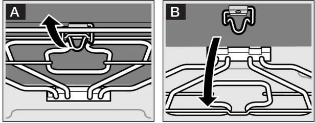
Après le nettoyage, repivoter la résistance du grill vers le haut. Pousser l'étrier de fixation vers le bas et enclencher la résistance du grill.
