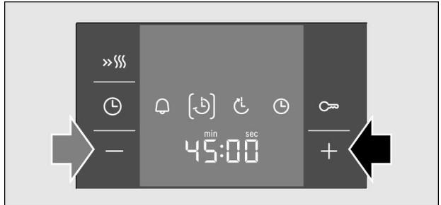
Le four se met en marche quelques secondes plus tard. La durée s'écoule visiblement à l'affichage et le symbole [🔔] est allumé. Les autres symboles de temps s'effacent.
