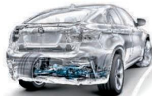
Dans un virage à droite, la roue arrière gauche est la plus à même de transmettre la force motrice à la chaussée. Le Contrôle Dynamique de la Transmission lui affecte donc davantage de couple.
