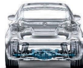
Lorsque vous roulez tout droit, le couple est réparti équitablement entre les deux roues de façon à garantir une poussée optimale.
