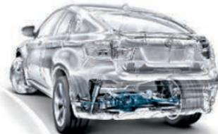
Dans un virage à gauche, le Contrôle Dynamique de la Transmission affecte davantage de force motrice à la roue arrière droite, car c'est elle qui est la plus à même de transmettre la puissance à la chaussée.
