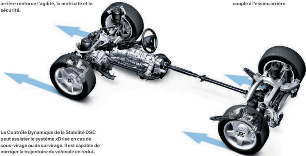
Le Contrôle Dynamique de la Stabilité DSC peut assister le système xDrive en cas de sous-virage ou de survirage. Il est capable de corriger la trajectoire du véhicule en réduisant la puissance du moteur et en freinant de manière ciblée une ou plusieurs roues.
