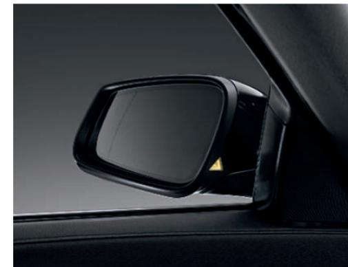
Affichage de l'avertisseur avancé d'angle mort sur la coque du rétroviseur extérieur.
