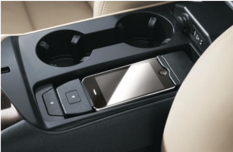
□ **Préparation pour téléphone portable Bluetooth** avec dispositif mains libres, connexion pour recharge et antenne extérieure. Un adaptateur enfichable disponible séparément permet de brancher un téléphone portable Bluetooth et de le recharger en roulant (en combinaison avec un système de navigation).
