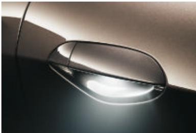
□ **Kit éclairage**. Les poignées extérieures avec éclairage intégré illuminent la zone d'accès au véhicule pendant 20 secondes après le déverrouillage des portes pour que vous puissiez monter à bord de votre véhicule en toute sécurité dans l'obscurité. Autres équipements compris : éclairage du rangement transversal, éclairage d'ambiance, liseuses et éclairage du bas de l'habitacle.
