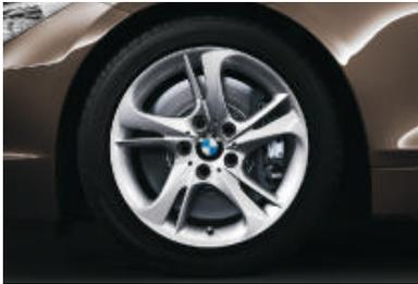
□ **Jantes en alliage léger 17" style turbine 292**, avec monte pneumatique mixte RSC permettant le roulage à plat. Dimensions : 8 J x 17 pouces à l'avant, pneumatiques 225/45 R 17 ; 8,5 J x 17 pouces à l'arrière, pneumatiques 255/40 R 17 (série sur Z4 sDrive35i).
