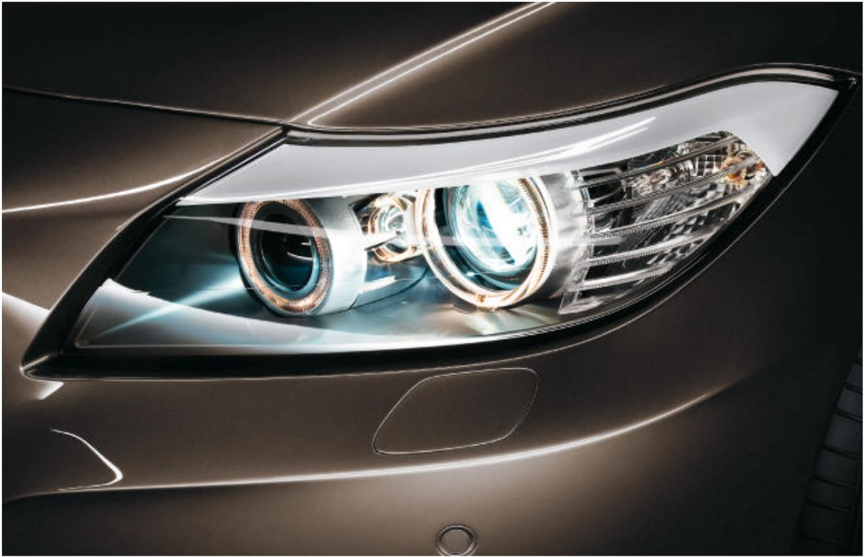
■ **Éclairage au Xénon pour les feux de croisement et les feux de route**, avec quatre anneaux lumineux pour fonction d'éclairage diurne, lave-phares et réglage automatique de la portée des projecteurs. Ils améliorent nettement l'éclairage de la chaussée la nuit ou par mauvaise visibilité.
