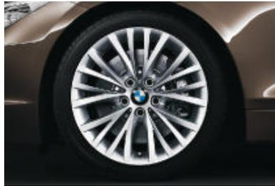
□ **Jantes en alliage léger 18" style 293 à rayons multiples**, avec monte pneumatique mixte RSC permettant le roulage à plat. Dimensions : 8 J x 18 pouces à l'avant, pneumatiques 225/40 R 18 ; 8,5 J x 18 pouces à l'arrière, pneumatiques 255/35 R 18.
