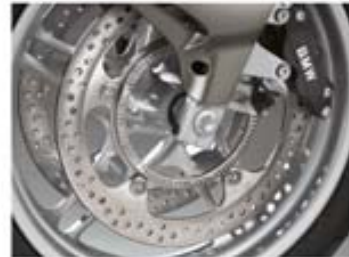
A l'avant, frein double disque de 320 mm de diamètre et étrier flottant à quatre pistons.
