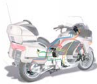
La parfaite automaticité de réglage de l'ABS Intégral BMW Motorrad de série, associée au modulateur de pression, permet des décélé-rations optimales en même temps qu'un dosage excellent.
