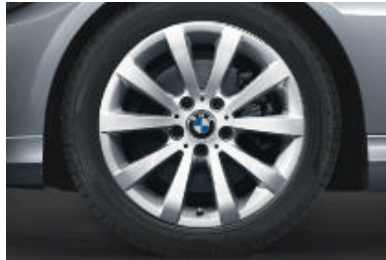
□ Jantes en alliage léger 17" style 285 à rayons en V , 8 J x 17 pouces, pneumatiques RSC permettant le roulage à plat 225/45 R 17 (de série sur les BMW 325i xDrive, 330i, 330i xDrive, 335i, 335i xDrive, 325d, 330d, 330d xDrive et 335d).
