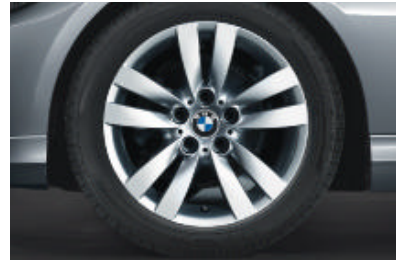
□ Jantes en alliage léger 17" style 161 à rayons doubles , 8 J x 17 pouces, pneumatiques RSC permettant le roulage à plat 225/45 R 17.
