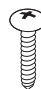
Schrauben für Standfuß 8 Stk.: M4 x 20 (Siehe S. A-3, A-4, A-5, A-6)
