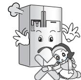
**Transporter le réfrigérateur à l'aide des poignées qui se trouvent en bas sur la partie avant et en haut sur la partie arrière de l'appareil.**
