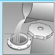
Avant le premier lavage seulement, versez env. un litre d'eau dans l'orifice du réservoir de sel.
