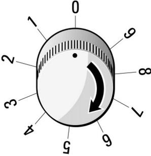
Les interrupteurs des foyers permettent de régler la puissance de chauffe des différents foyers.
