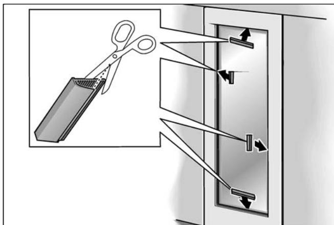
Si le cadre est d'une largeur réduite, il faudra le cas échéant raccourcir la branche de la baguette couvre-joints. Pour déterminer la longueur requise de la branche, des échantillons de baguette ont été livrés d'origine.
