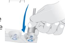
Mettez le nouveau dôme sur l'écouteur. La marque sur l'écouteur vous permet de positionner correctement le dôme.
