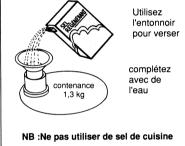
Après le remplissage, effectuez les opérations dans l'ordre inverse pour le remontage. Important : bien resserrer le bouchon du réservoir à sel.
