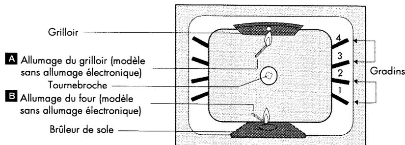
Une seule manette de thermostat contrôle le fonctionnement soit du four, soit du grilloir.
