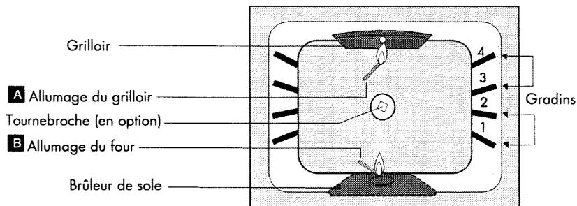
Une seule manette de thermostat contrôle le fonctionnement soit du four, soit du grilloir.
