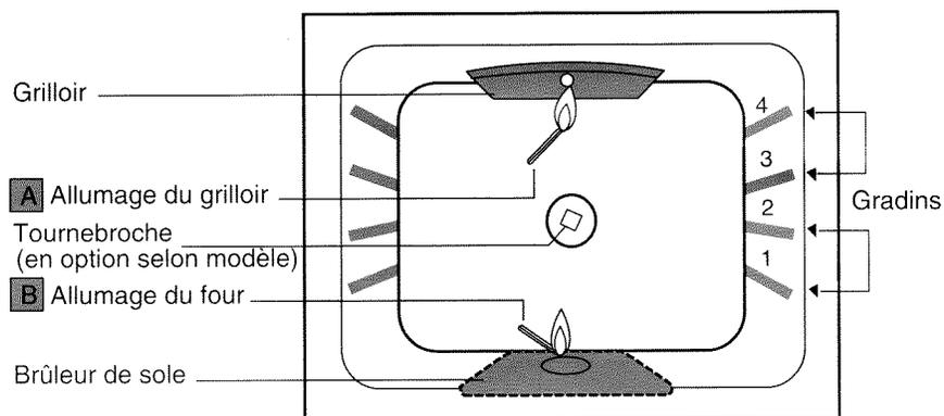
**A allumage du grilloir :** Présentez une allumette sous le brûleur de grilloir ou appuyez sur le bouton d'allumage électronique (selon modèle). Poussez et tournez la manette du thermostat en déplaçant dans le sens le repère grilloir de façon à l'amener en coïncidence avec celui du bandeau. S'assurer que le brûleur est totalement allumé.
