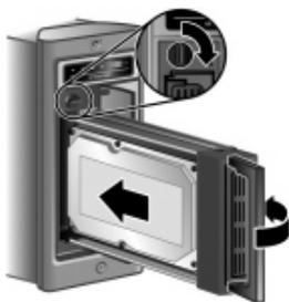
9. Tournez le bouton de sécurité dans le sens des aiguilles d'une montre pour assurer la position du plateau.
