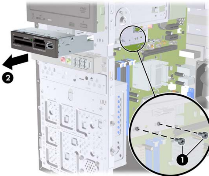
Figure 2-24 Retrait d'un périphérique 3,5 pouces (lecteur de carte multimédia illustré)
