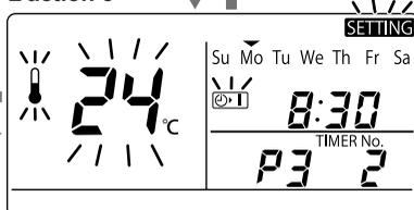
L'appareil intérieur change le réglage de température à l'heure programmée.
