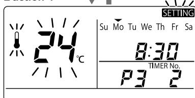
L'appareil intérieur se met en marche à l'heure programmée et change le réglage de température.
