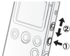
Appuyez sur l'interrupteur pendant 1 seconde pour mettre l'appareil en marche. ①
