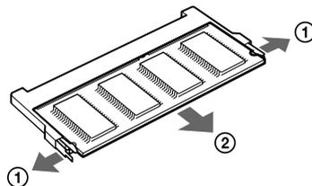
Tirez les tenons dans le sens indiqué par les flèches. Le module de mémoire se détache.
