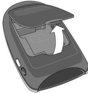
2. Placer le jeu de piles dans le compartiment piles.
