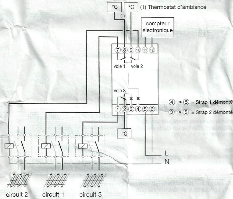
Les 3 sorties doivent être en mode contact, c'est à dire straps 1 et 2 démontés.
