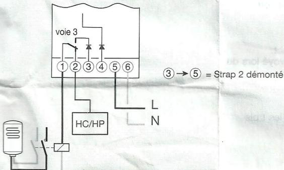
La sortie 3 doit être en mode contact, donc strap 2 démonté.
