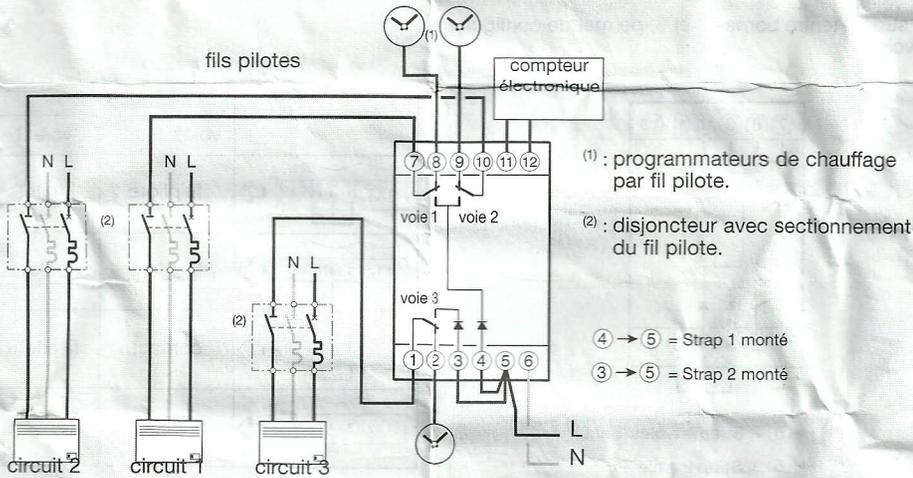
Les 3 sorties doivent être en mode fil pilote, c'est à dire straps 1 et 2 montés.
