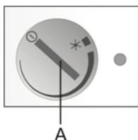
Le réglage recommandé pour le bouton du thermostat A est la position médiane entre la partie fine et la partie large du symbole.
