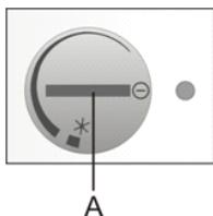
Pour mettre l'appareil à l'arrêt, tournez le bouton A en sens inverse et positionnez le curseur en face de l'icône (l'appareil demeure sous tension).
