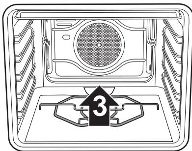
3. Remettez la base d'appui de la pierre à pizza en place en la poussant jusqu'à la butée contre l'arrière de la cavité de cuisson et faites-la descendre de manière à encasturer la platine de la résistance avec la base même.
