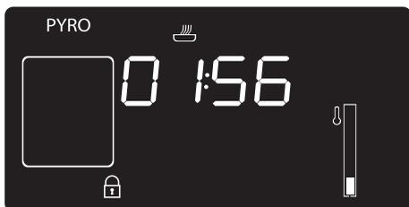
1. L'afficheur indique le message **PYRO ECO** ou **PYRO ECO** et le temps restant pour signaler que l'appareil est en train d'effectuer le cycle de nettoyage automatique.
