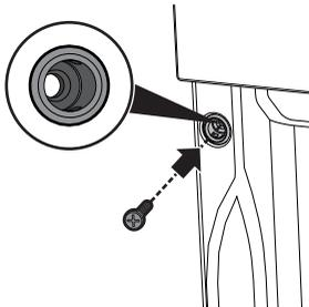
4. Couvrez les douilles avec les bouchons démontés précédemment.
