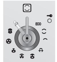
Une minute après le début du cycle de nettoyage (Pyrolyse), un bloque-porte intervient et empêche l'ouverture de la porte. L'intervention de ce blocage est signalée par l'allumage du voyant spécifique.
