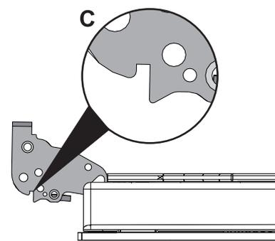
Pour remonter la porte, introduisez les charnières dans les fentes prévues à cet effet sur le four en s'assurant que les rainures C sont complètement posées contre la base des fentes. Abaissez la porte puis, après l'avoir positionnée, sortez les pivots des trous des charnières.
