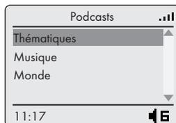
4 Sélectionner le podcast à l'aide du bouton **»V«** ou **»^«** ou alors en utilisant la commande Jog-Shuttle et appuyer sur **»OK«** pour confirmer.
