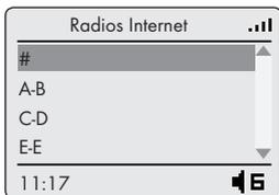
3 Appuyer sur »▼« ou »▲« ou utiliser la commande Jog-Shuttle pour sélectionner la station recherchée puis appuyer sur »OK« pour confirmer.
