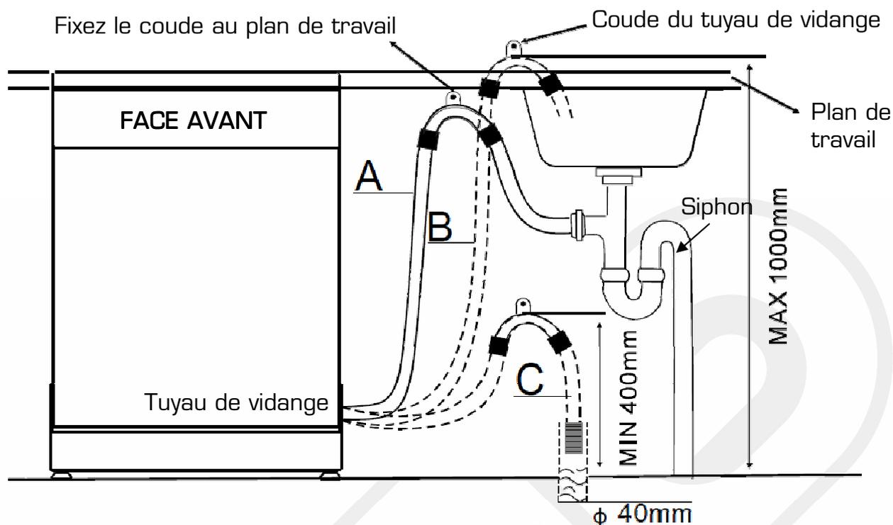
Le tuyau de vidange doit être correctement attaché pour éviter toute fuite d'eau.
