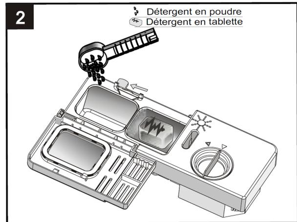
1. Appuyez sur le bouton de déverrouillage pour ouvrir le compartiment du produit de lavage.
