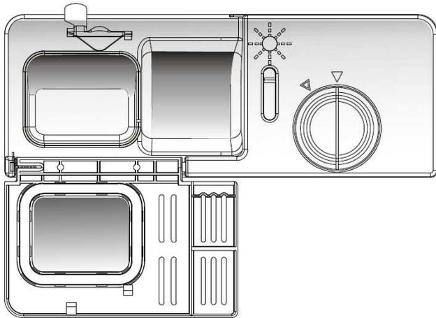
☞ *Le distributeur de liquide de rinçage se trouve sur la face intérieure de la porte, à côté du distributeur de détergent.*
