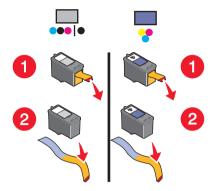
**Warnung:** Sie sollten *keinesfalls* den goldfarbenen Kontaktbereich an der Rückseite oder die Metalldüsen an der Unterseite der Patronen berühren.
