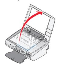
3 Legen Sie das Originaldokument mit der Vorderseite nach unten in die untere rechte Ecke auf das Scannerglas.
