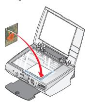
4 Schließen Sie die obere Abdeckung, damit keine dunklen Ränder im gescannten Bild entstehen.
