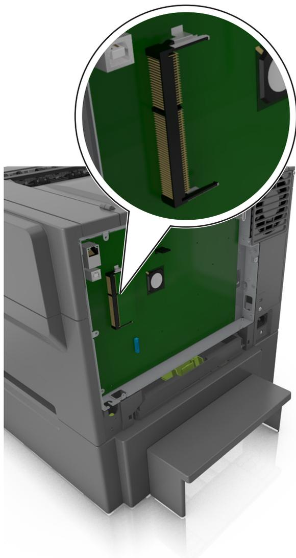
**Attention — Dommages potentiels :** Les composants électroniques de la carte contrôleur sont très vulnérables à l'électricité statique. Touchez une partie métallique de l'imprimante avant de manipuler les composants électroniques ou connecteurs de la carte contrôleur.
