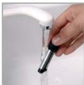
La buse vapeur est démontable pour permettre un nettoyage en profondeur. Lavez-la avec de l'eau et un peu de savon à vaisselle non abrasif au moyen d'une brosse. Rincez-la et séchez-la. Avant de la remettre en place, assurez-vous que les trous d'entrée d'air ne sont pas bouchés par des résidus de lait. Débouchez-les avec l'aiguille fournie si nécessaire. Ne pas laver la buse vapeur dans un lave-vaisselle.
