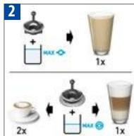
2 Remplissez le mousser à lait jusqu'à l'un des deux niveaux «max».
