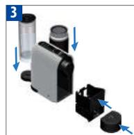
**⚠** Insérez le bac d'égouttage, l'Aeroccino et le collecteur de capsules usagées. Pour votre sécurité, utilisez la machine uniquement avec le bac d'égouttage et le collecteur de capsules usagées en place.
