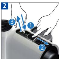
Appuyez et maintenez le bouton choisi lors de la fermeture de la fenêtre coulissante; relâchez le bouton lorsque le volume souhaité est atteint. Les 2 autres boutons clignotent pour confirmation. Touch and hold the control while closing the slider. Release control when desired volume is reached. The other 2 controls flash for confirmation.
