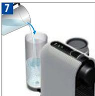
Remplissez le réservoir d'eau avec la solution de détartrage usagée recueillie dans le récipient et touchez n'importe quel bouton pour répéter la procédure.
