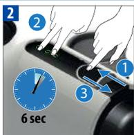
Ouvrez la fenêtre coulissante. Maintenez appuyé les boutons Ristretto et Lungo ensemble pendant au moins 6 sec. L'autre bouton clignote pour confirmation. Puis fermez la fenêtre coulissante pour démarrer l'opération. Open slider. Press and hold the Ristretto & Lungo controls together for at least 6 sec. The other control flash for confirmation. Then close the slider to start procedure.
