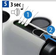
Pour enclencher le détartrage, après avoir verrouillé la fermeture coulissante, appuyez en même temps sur les 3 boutons de commande pendant au moins 3 secondes. Un court signal sonore confirmera l'enclenchement. Ouvrez la fenêtre coulissante.
