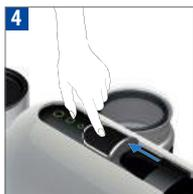
**4** Allumez la machine en poussant la fenêtre coulissante vers l'arrière de la machine. Voyant clignotant: chauffage pendant approx. 25 sec. Voyant allumé en continu: prêt. La machine peut être mise en mode Arrêt à tout moment quand la fenêtre coulissante est fermée en maintenant appuyé un des boutons tactiles pendant plus de 3 sec, confirmé par les 2 autres boutons clignotants.
