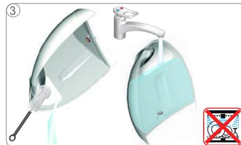
3 Rincez et nettoyez le réservoir d'eau. Versez ensuite de nouveau de l'eau potable fraîche dans le réservoir et introduisez celui-ci dans la machine. Le réservoir d'eau n'est pas conçu pour le lave-vaisselle!
