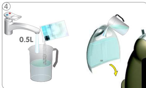
④ Mélangez 0.5 litre d'eau potable fraîche avec un sachet de détartrant dans un gobelet mesureur. Versez la solution détartrante dans le réservoir d'eau et insérez le réservoir d'eau dans la machine.
