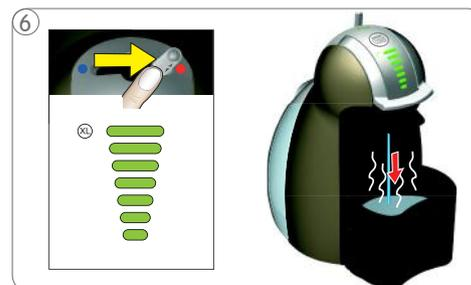
6 Continuez à rincer la machine avec de l'eau chaude: Poussez le levier vers le haut jusqu'au dosage maximal. Déplacez le levier vers la droite pour préparer une boisson chaude.
