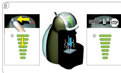
⑧ Déplacez le levier vers la gauche. Les témoins lumineux commencent à compter à rebours. La machine se démarre en mode marche/arrêt pendant 2 min. environ. Le levier revient en position centrale.
