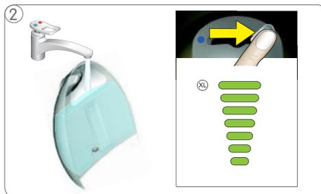
Vérifiez s'il y a de l'eau dans le réservoir: si ce n'est pas le cas, remplissez le réservoir, réappuyez sur le bouton d'eau chaude/froide pour continuer la préparation; si le réservoir est plein, procédez comme suit:
