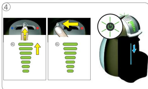
4 Commencez par rincer avec de l'eau froide: Poussez le levier vers le haut jusqu'au dosage maximal. Déplacez le levier vers la gauche pour préparer une boisson froide.
