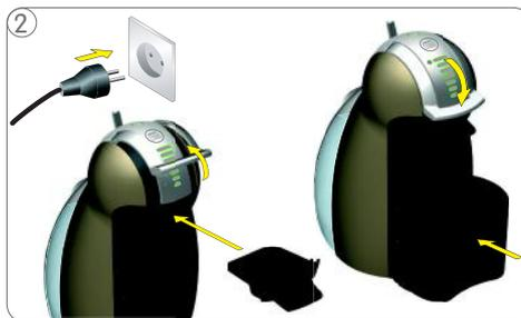
2 Ouvrez la poignée de verrouillage et insérez un porte capsule vide. Fermez la poignée. Placez un contenant de 1L sur le porte-tasse. Branchez la machine sur une prise de courant.
