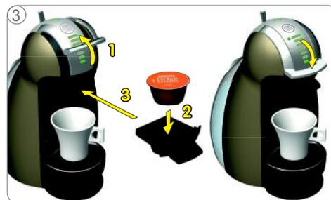
3 Ouvrez la poignée de verrouillage et sortez le porte capsule. Insérez une capsule dans le porte-capsule et réintroduisez celui-ci dans la machine. Fermez la poignée.
