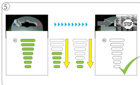
5 Le rinçage démarre. Attendez la fin du compte à rebours lumineux. La machine s'arrête et le levier revient en position centrale.
