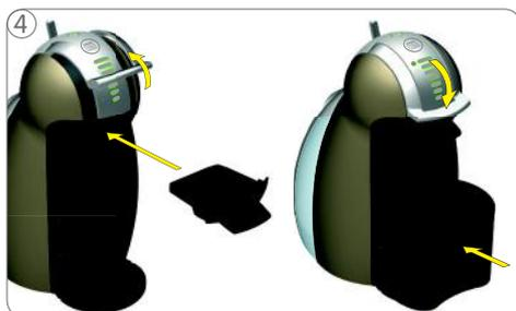
4 Ouvrez la poignée de verrouillage et insérez un porte capsule vide. Fermez la poignée de verrouillage et placez le bac à capsules usagées sous la sortie.
