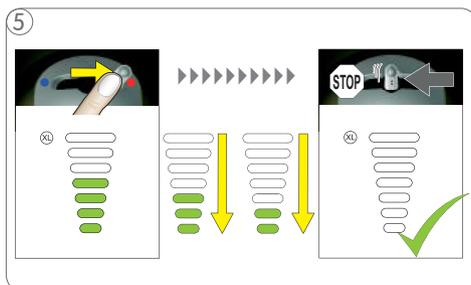
5 Déplacez le levier vers la droite pour des boissons chaudes et vers la gauche pour des boissons froides. La préparation de la boisson démarre. Les niveaux de dosage disparaissent progressivement. La machine arrête la préparation de la boisson automatiquement. L'extraction de la boisson peut être arrêtée manuellement en déplaçant le levier vers la position centrale.
