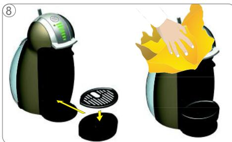
8 Placez la grille d'égouttage sur le bac d'égouttage. Insérez ensuite le bac d'égouttage à la position souhaitée sur la machine. Nettoyez la machine avec un chiffon doux humide. Essuyez-la ensuite avec un chiffon doux sec.
