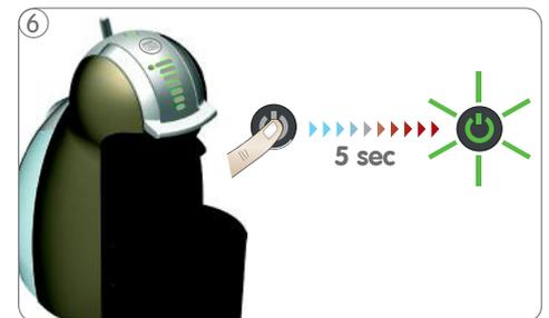
⑥ Appuyez sur le bouton pendant 5 secondes au moins. Le bouton marche/arrêt se met à clignoter en vert et la machine se règle en mode détartrage.
