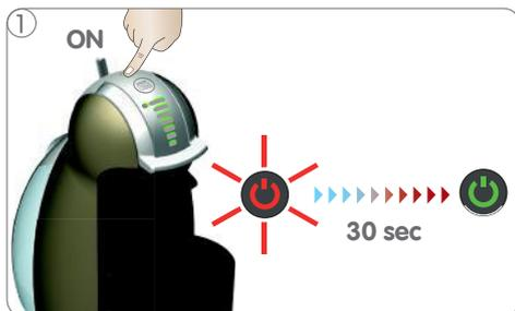
1 Allumez la machine. Pendant la mise en température, le bouton marche/arrêt se met à clignoter en rouge. Au bout d'environ 30 secondes, le bouton marche/arrêt émet une lumière verte continue et la machine est prête.
