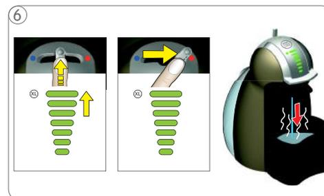
6 Nettoyez la machine en suivant les instructions. Faites apparaître le niveau de dosage maximum à l'aide du levier puis déplacez le vers la droite. La machine démarre le nettoyage. Les niveaux de dosage disparaissent progressivement.
