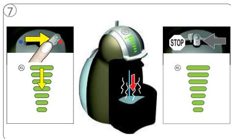
⑦ Déplacez le levier vers la droite. Les témoins lumineux commencent à compter à rebours. La machine se démarre en mode marche/arrêt pendant 2 min. environ. Le levier revient en position centrale.
