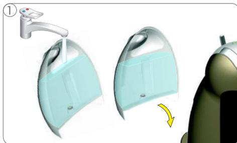
1 Rincez d'abord le réservoir d'eau. Versez de l'eau potable fraîche dans le réservoir et insérez-le dans le réservoir.
