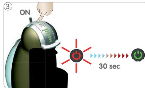
3 Allumez la machine. Pendant la mise en température, le bouton marche/arrêt se met à clignoter en rouge. Au bout d'environ 30 secondes, le bouton marche/arrêt émet une lumière verte continue et la machine est prête.
