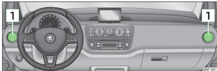
Fig. 74 Diffuseurs d'air
