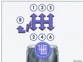
Fig. 103 Grille des vitesses de la boîte mécanique à 5 ou 6 vitesses.
