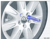
Fig. 162 Changement d'une roue : dévissage des boulons de roue à l'aide du manche de tournevis
