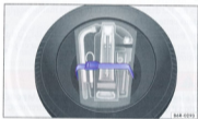
Fig. 153 Dans le coffre à bagages, sous le revêtement de plancher : roue de secours et boîte à outils sans boule amovible.
