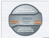
Fig. 129 Dans le compartiment-moteur : bouchon de l'orifice de remplissage d'huile-moteur.
