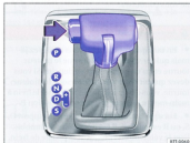
Fig. 104 Véhicules à direction à gauche : levier sélecteur de la boîte automatique avec touche de blocage (flèche).
