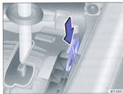
Fig. 152 Déverrouillage d'urgence du blocage du levier sélecteur.
