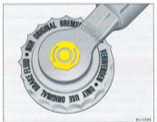
Fig. 109 Dans le compartiment-moteur : bouchon du réservoir de liquide de frein
