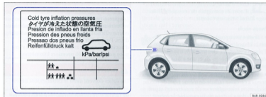
Fig. 138 Plaque de pression de gonflage dans la trappe à carburant.
