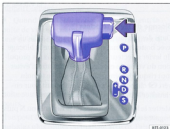
Fig. 105 Véhicules à direction à droite : levier sélecteur de la boîte automatique avec touche de blocage (flèche).
