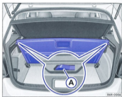
Fig. 77 Hayon ouvert : plancher modulable de coffre à bagages relevé et fixé.
