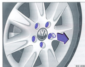
Fig. 157 Retrait des capuchons de boulons de roue
