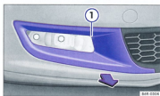
Fig. 171 Dans le pare-chocs avant, du côté droit : dépose du cache du projecteur.
