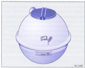
Fig. 130 Dans le compartiment-moteur : repères sur le vase d'expansion du liquide de refroidissement.
