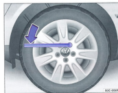
Fig. 158 Changement d'une roue : desserrage des boulons de roue
