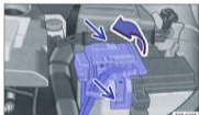
Fig. 132 Dans le compartiment-moteur : retrait du boîtier à fusibles de la batterie du véhicule
