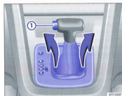
Fig. 151 Déposez le cache de la coulisse de changement de vitesses.
