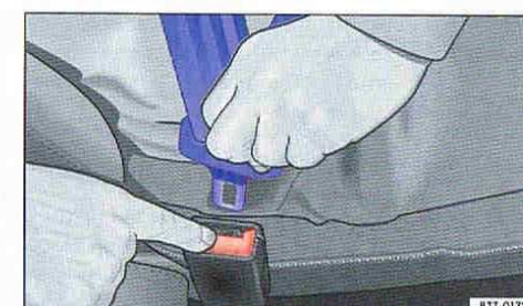
Fig. 40 Retrait du pêne du boîtier de verrouillage.
