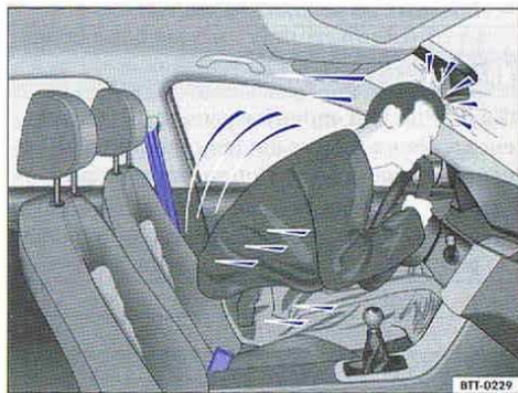
Fig. 36 Le conducteur non sanglé est projeté en avant.
