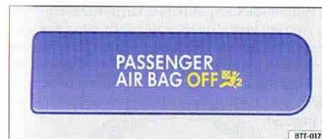
Fig. 44 Témoin de désactivation du sac gonflable frontal du passager avant.
