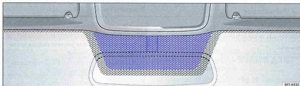
Fig. 61 Pare-brise réfléchissant avec fenêtre de communication (surface bleue).
