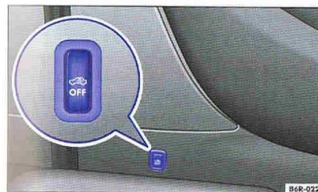
Fig. 16 À côté du siège du conducteur : touche de désactivation de la protection volumétrique et de la protection anti-soulèvement.
