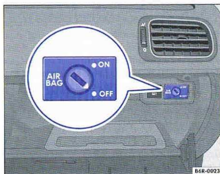
Fig. 47 Dans le rangement côté passager avant : commande à clé de désactivation et d'activation du sac gonflable frontal du passager avant.
