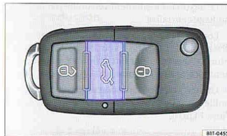
Fig. 19 Clé du véhicule avec touche de déverrouillage du hayon.
