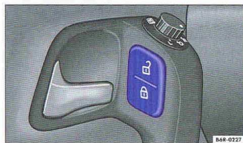
Fig. 15 Dans la porte du conducteur : touche de verrouillage centralisé.
