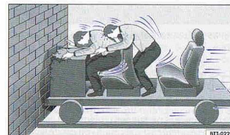
Fig. 35 Véhicule avec des occupants non sanglés heurtant le mur.
