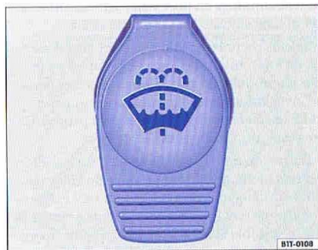
Fig. 67 Dans le compartiment-moteur : bouchon du réservoir de liquide de lave-glace.
