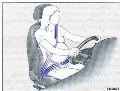
Fig. 42 Ajustement correct de la sangle recommandé pour les femmes enceintes.
