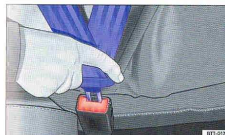
Fig. 39 Insertion du pêne de la ceinture de sécurité dans le boîtier de verrouillage.
