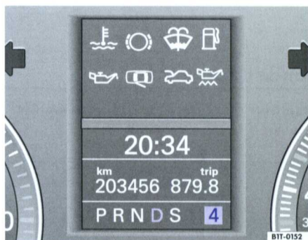
Fig. 101 Détail du combiné d'instruments : affichage levier sélecteur avec levier en position D et rapport de quatrième engagé
