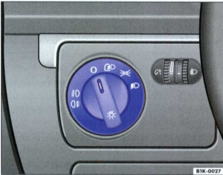
Fig. 34 Détail du tableau de bord : commandes d'éclairage, des projecteurs antibrouillards et du feu arrière de brouillard
