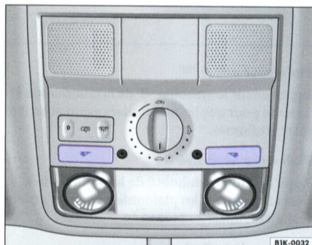
Fig. 39 Détail du ciel de pavillon : lampes de lecture avant
