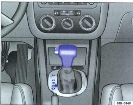
Fig. 98 Détail de la console centrale : levier sélecteur de la boîte automatique ou de la boîte DSG
