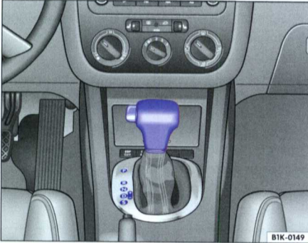
Fig. 97 Détail de la console centrale : levier sélecteur de la boîte automatique ou de la boîte DSG
