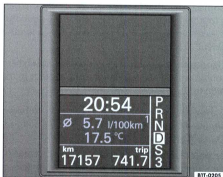
Fig. 10 Afficheur dans le combiné d'instruments : indicateur multifonction avec affichage de la température extérieure
