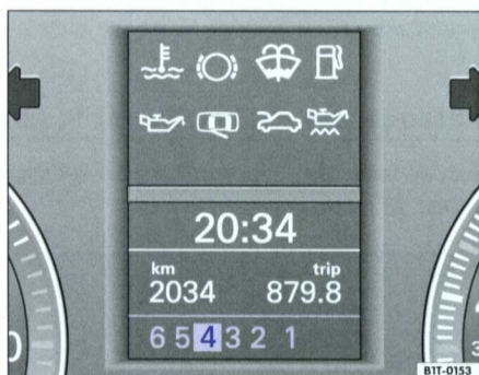
Fig. 102 Détail du combiné d'instruments : affichage du quatrième rapport en mode tiptronic
