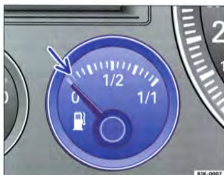
Fig. 6 Détail du combiné d'instruments : indicateur du niveau de carburant
