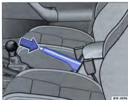
Fig. 103 Frein à main entre les sièges avant
