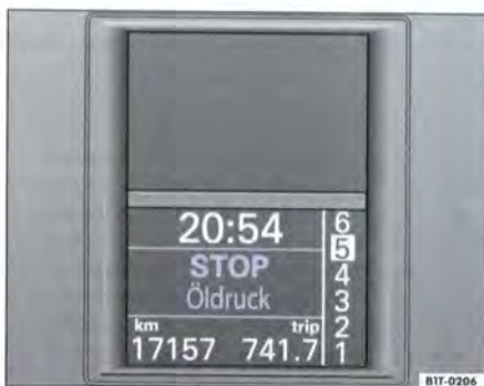
Fig. 11 Message d'avertissement dans l'afficheur : STOP PRESSION D'HUILE
