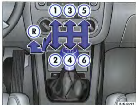
Fig. 95 Détail de la console centrale : grille des vitesses de la boîte mécanique à 6 vitesses
