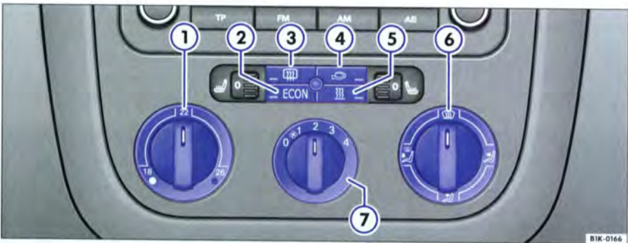
Fig. 85 Dans la console centrale : éléments de commande du Climatic
