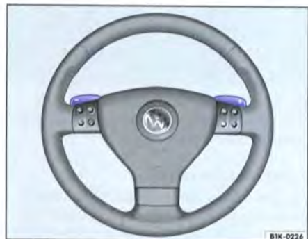
Fig. 100 Volant multifonction avec palettes pour passage des rapports de la boîte automatique
