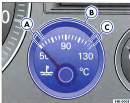
Fig. 5 Détail du combiné d'instruments : indicateur de température de liquide de refroidissement
