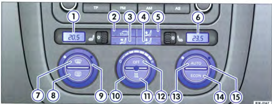
Fig. 90 Sur la console centrale : éléments de commande du Climatronic
