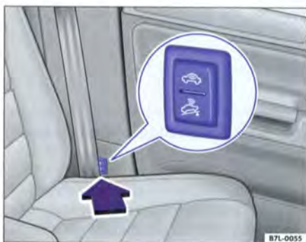
Fig. 26 Touche de désactivation de la protection volumétrique et de la protection anti-soulèvement
