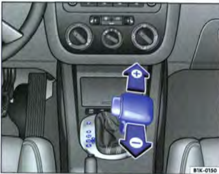
Fig. 99 Détail de la console centrale : boîte automatique ou boîte DSG avec levier sélecteur dans la voie de passage tiptronic
