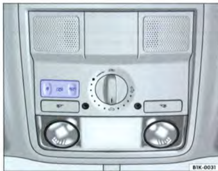
Fig. 38 Détail du ciel de pavillon : plafonnier avant
