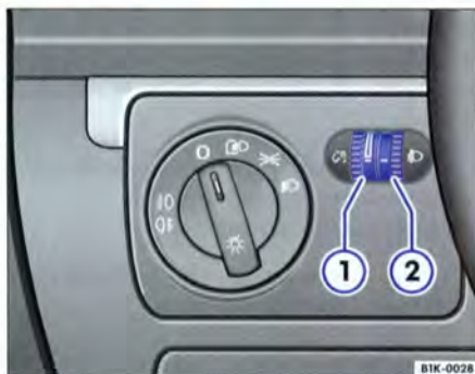
Fig. 35 Détail du tableau de bord : molettes du rhéostat d'éclairage des cadrans et des commandes et du réglage du site des projecteurs
