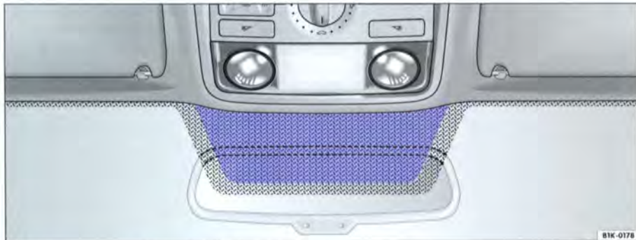
Fig. 46 Pare-brise réfléchissant avec fenêtre de communication (surface bleue)
