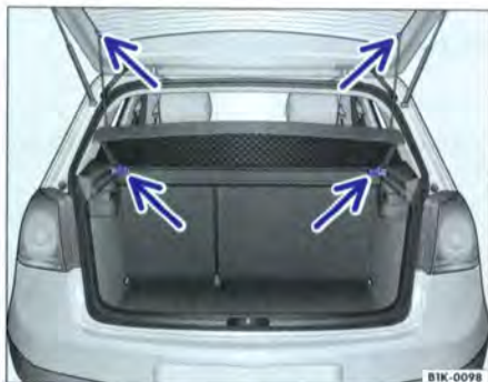
Fig. 81 Dépose et repose du couvre-coffre
