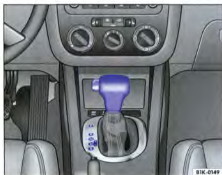
Fig. 96 Détail de la console centrale : levier sélecteur de la boîte automatique ou de la boîte DSG
