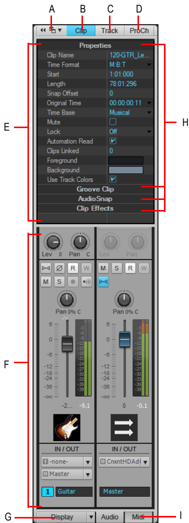
A. Ancrer/Détacher l'Inspecteur B. Afficher/Masquer l'Inspecteur de propriétés de clip C. Afficher/Masquer l'Inspecteur de propriétés de piste D. Afficher/Masquer ProChannel E. Zone d'affichage de l'Inspecteur de propriétés F. Zone d'affichage des Inspecteurs de pistes G. Afficher/Masquer/Configurer les modules H. Barres d'en-tête des sections (cliquez pour afficher les commandes) I. Afficher la sortie audio ou les paramètres MIDI (pistes d'instrument uniquement)
