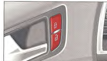
Fig. 25 Porte du véhicule : commande de verrouillage centralisé
