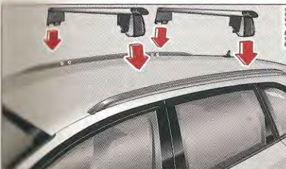
Fig. 77 Barres de toit : montage de la galerie porte-bagages
