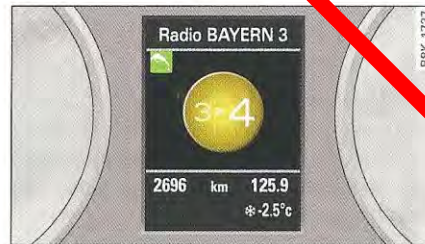
Fig. 16 Combiné d'instruments : indicateur élargi de changement de rapport
