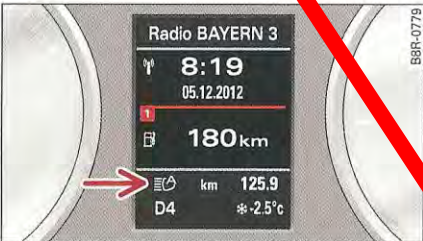
Fig. 40 Combiné d'instruments : témoin de l'assistant de feux de route
