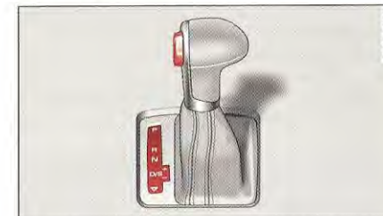
Fig. 118 Vue partielle de la console centrale : levier sélecteur avec touche de blocage
