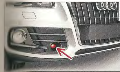
Fig. 123 Partie avant du véhicule : capteur de radar
