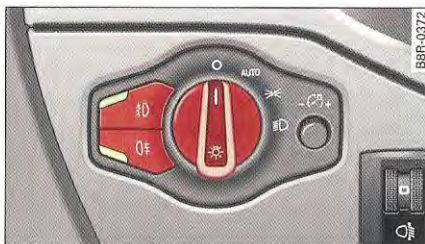
Fig. 36 Tableau de bord : commande d'éclairage
