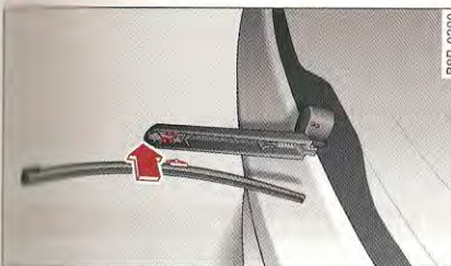
Fig. 52 Essuie-glace arrière : démontage du balai d'essuie-glace
