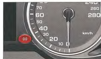
Fig. 7 Combiné d'instruments : touche de remise à zéro
