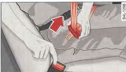
Fig. 175 Libération du pêne du boîtier de verrouillage
